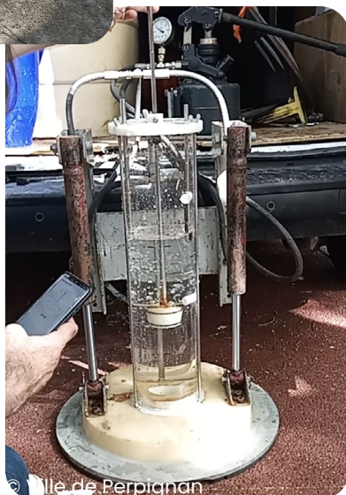
Utilisation du drainomètre pour apprécier la bonne pose du revêtement drainant dans la cour
